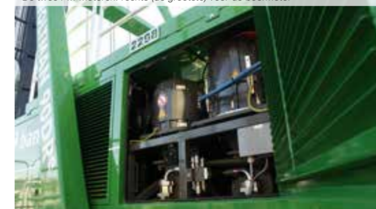
De twee PM-motoren: rechts (de grootste) voor de boormotor
