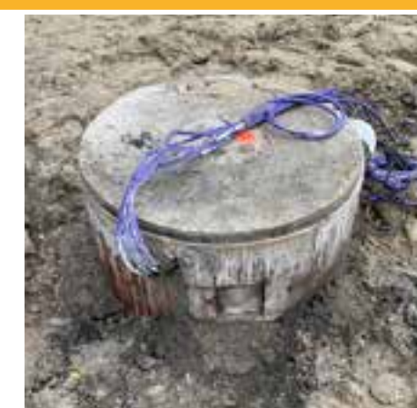
Geprepareerde paalkop klasse A2, klaar voor testen
