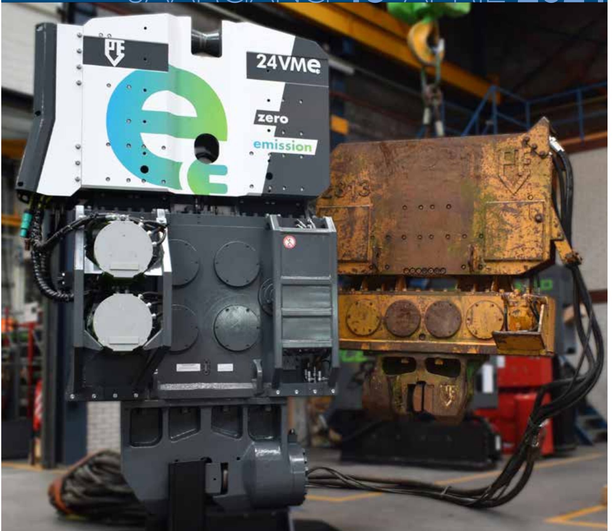
Bijna 40 jaar leeftijdsverschil en toch kunnen beide trilblokken emissieloos worden aangedreven. Voor oudere blokken biedt Dieseko een hybride zero-emissie aandrijving met de EHPU-range powerunits, de PVE 24VMe komt dit najaar op de markt als het eerste elektrisch aangedreven trilblok van Dieseko.
